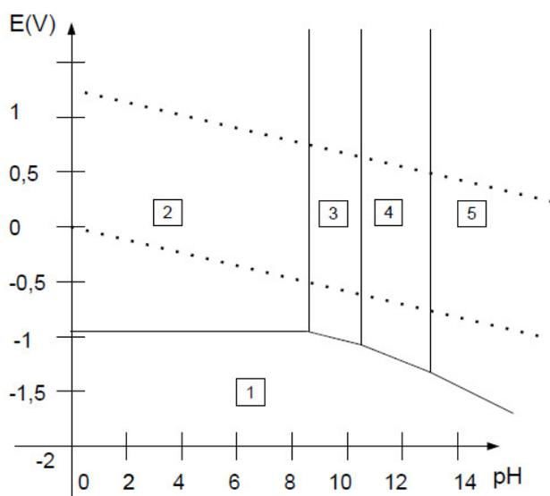
FIGURE 2 – Diagramme potentiel-pH du zinc et de l'eau
